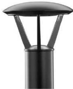
L'apparecchio è specificamente studiato per l'illuminazione a led di percorsi pedonali, presenta dimensioni ridotte e grado di protezione IP65. Il modulo LED è posizionato nella parte superiore della calotta per un miglior controllo ottico ed è formato da n. 18 diodi luminosi, per una potenza di sistema pari a 23 W. La temperatura di colore è 6.000 K con resa cromatica 75.
