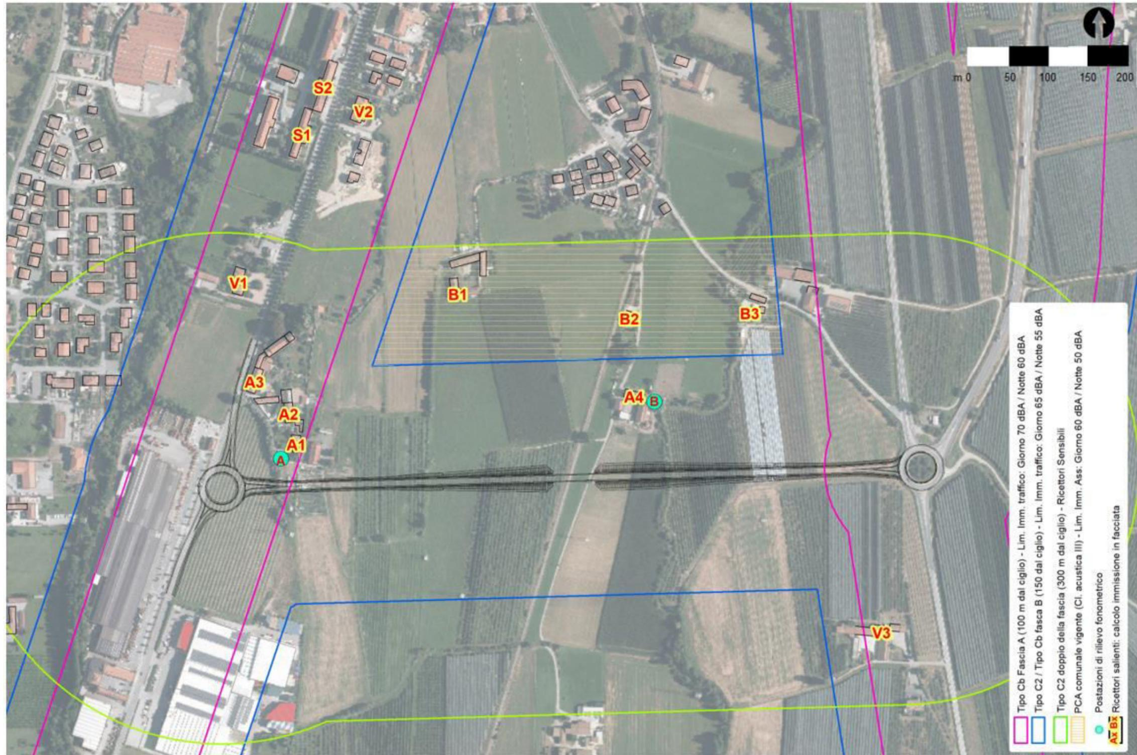
Figura 4.2.1/1 Inquadramento generale - Ricettori esposti - Limiti applicabili - Posizione delle postazioni di rilievo fonometrico
