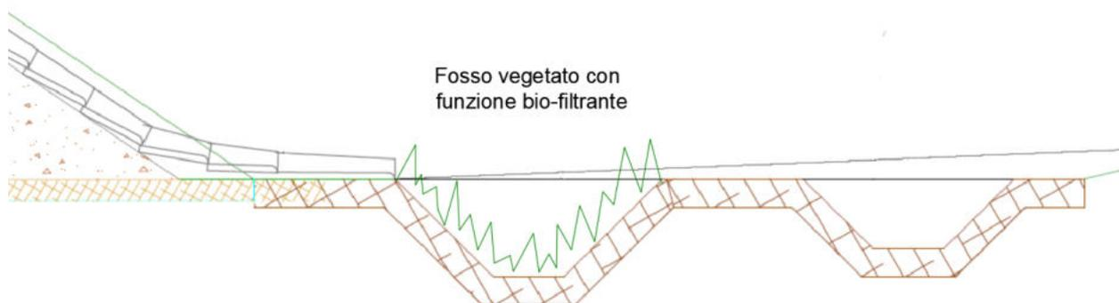
Figura 4.6.10/3 Posizione dei fossi vegetati bio-filtranti lungo il tracciato (il fossi accanto è quello di guardia)
